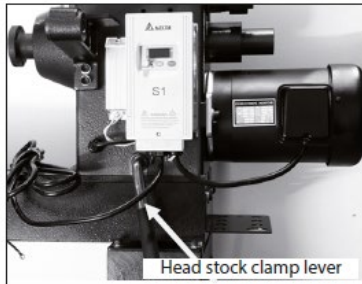
Head stock clamp lever - dźwignia blokady głowicy
