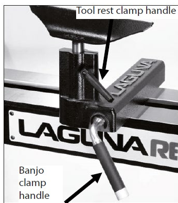
Tool rest clamp handle – blokada podpórki Banjo rest clamp handle – uchwyt blokujący podpórkę
