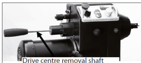
Drive centre removal shaft – otwór do wypychania trzpienia
